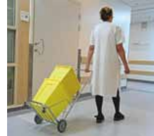
Art nr 8075-00 All-roundvagn för bl a riskavfallsboxar. Med höj/sänkbart handtag vilket underlättar t ex vid intertransport till miljö- rum. Förkromad, 2 länkhjul Ø 50 mm och 2 fasta hjul Ø 150 mm. B x d x h = 470x470x710/1035 mm.
