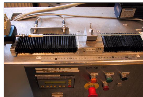
Kälken drar blocket fram och tillbaka på katetern metallpinne förs in i katetern
