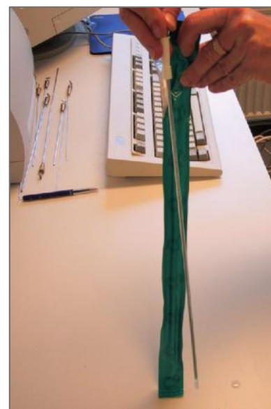
Kälken drar blocket fram och tillbaka på katetern metallpinne förs in i katetern
