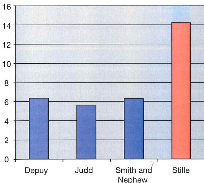
Diagrammet indikerar skärdjup i mm som åstadkommits på 60 sekunder. Tio testbitar fixerades i en mekanisk testapparat och medelvärdet av samtliga skärdjup beräknades. Resultaten indikerar att Stilles Giglisåg var mer än dubbelt så effektiv på att avlägsna material än de andra sågar som testades.
