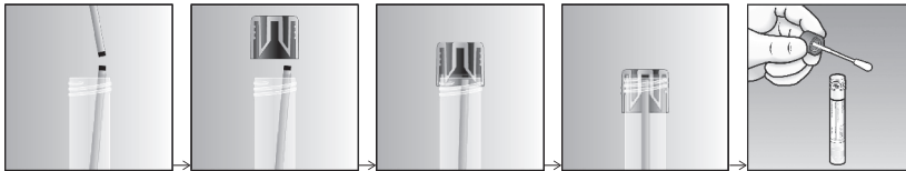
Мал. 2. Фіксація зламаного стрижня аплікатора зонд-тампона ковпачком пробірки ESwab®
