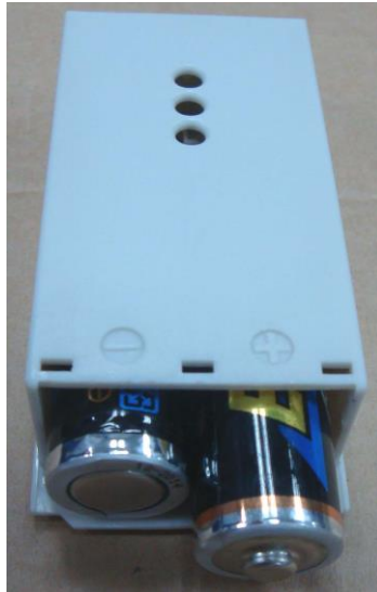
Figur 3-2 Sette batterier i batteriromdekselet
