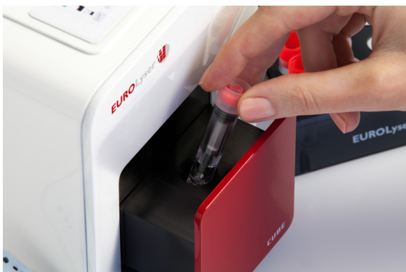
Sett testkyvetten i instrumentet
