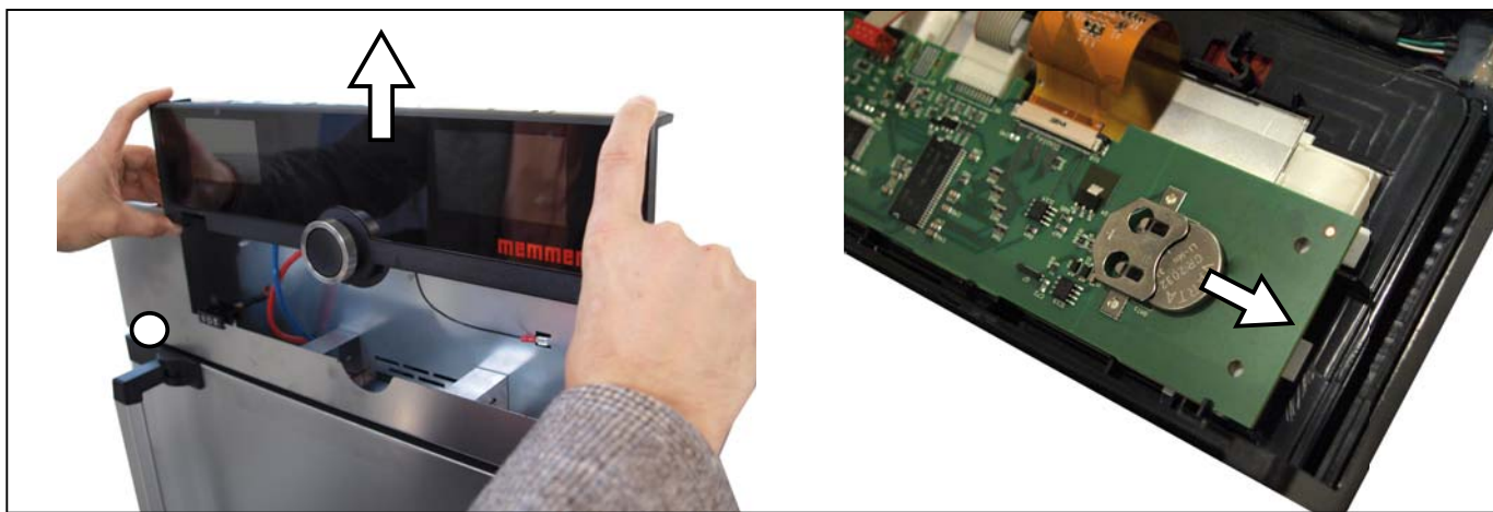
Fig. 25 Fjernelse af litiumbatteri
